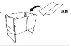
❸空気の通り道を作り、燃焼効率を良くするため、 ロストルを燃焼室に入れます。
